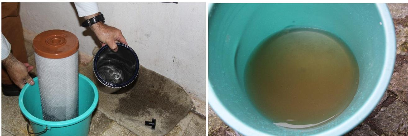
Sustituya el cartucho viejo con el cartucho nuevo (¡habiendo retirado previamente el plástico de embalaje!) Teniendo en cuenta el lado ARRIBA = orificio abierto en la parte superior del cartucho, hacia arriba:
