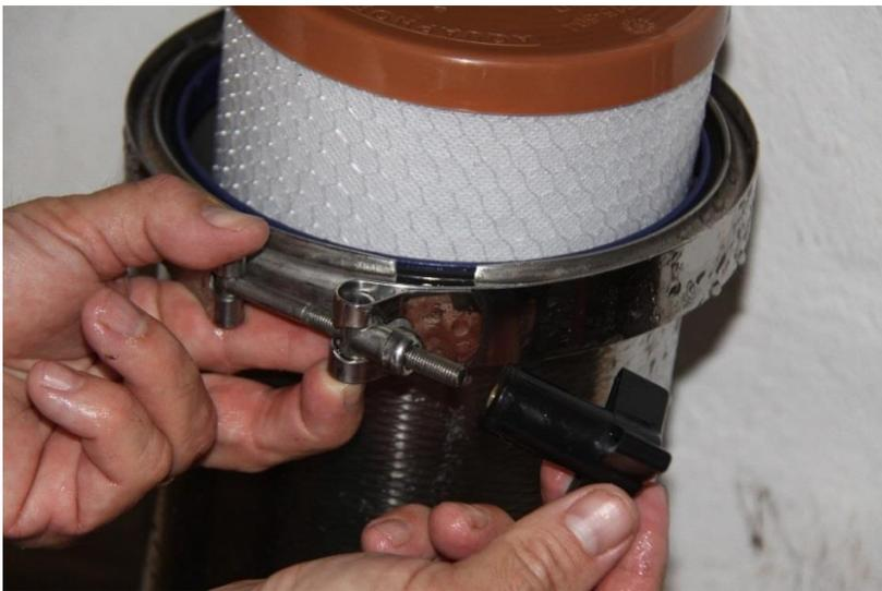
Asegúrese de que la diapositiva del fleje de acero inoxidable del filtro Aquaphor sigue los contornos de la carcasa del dispositivo como se ilustra en las fotos a continuación:
