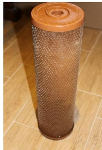
*Foto de óxido (de tuberías galvanizadas de la compañía de agua) saturando un cartucho no reemplazado*
